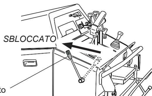
5 ) Spostare la leva frizione della trasmissione in posizione **ON**.
