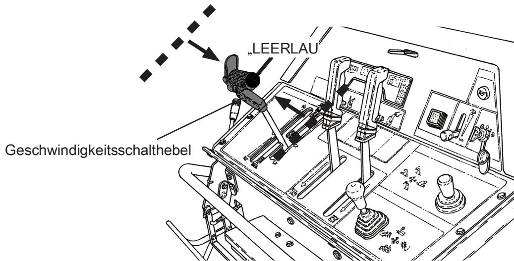
5 .Sicherstellen, dass der Fahrkupplungshebel auf „AUS“ steht, siehe Abbildung.
