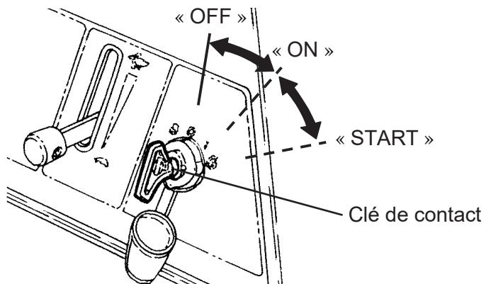
9. Après le démarrage du moteur, le faire fonctionner sans appliquer de charge pour le préchauffer pendant 5 minutes.
