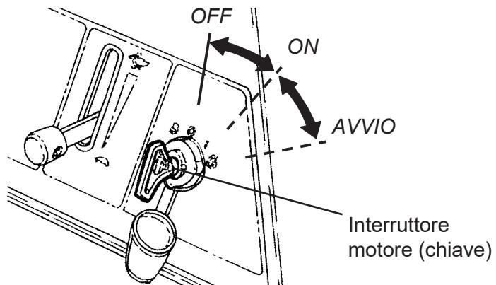
9 . Dopo l'avviamento del motore, farlo funzionare senza applicare alcun carico per riscalarlo 5 min.
