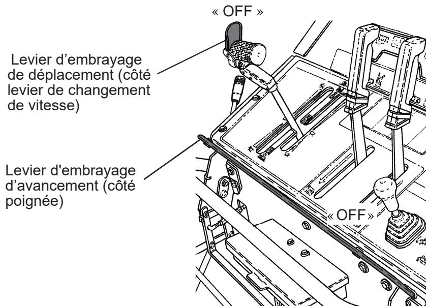
6. Déplacer légèrement le levier de réglage de la rotation du moteur dans la direction indiquée par la flèche.
